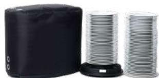
Heating Plate formado por una base termoconvectiva que se enchufa en cualquier lugar a la corriente eléctrica, y de una funda isotérmica adaptada a cada uno de los tres lotes de platos, calentándolos a la vez a 50/55°C. Diámetro de plato hasta 300 mm. Peso 2,45 Kg. Consumo eléctrico 850 w. Monofásico. Disponible para 40/80/120 platos.
