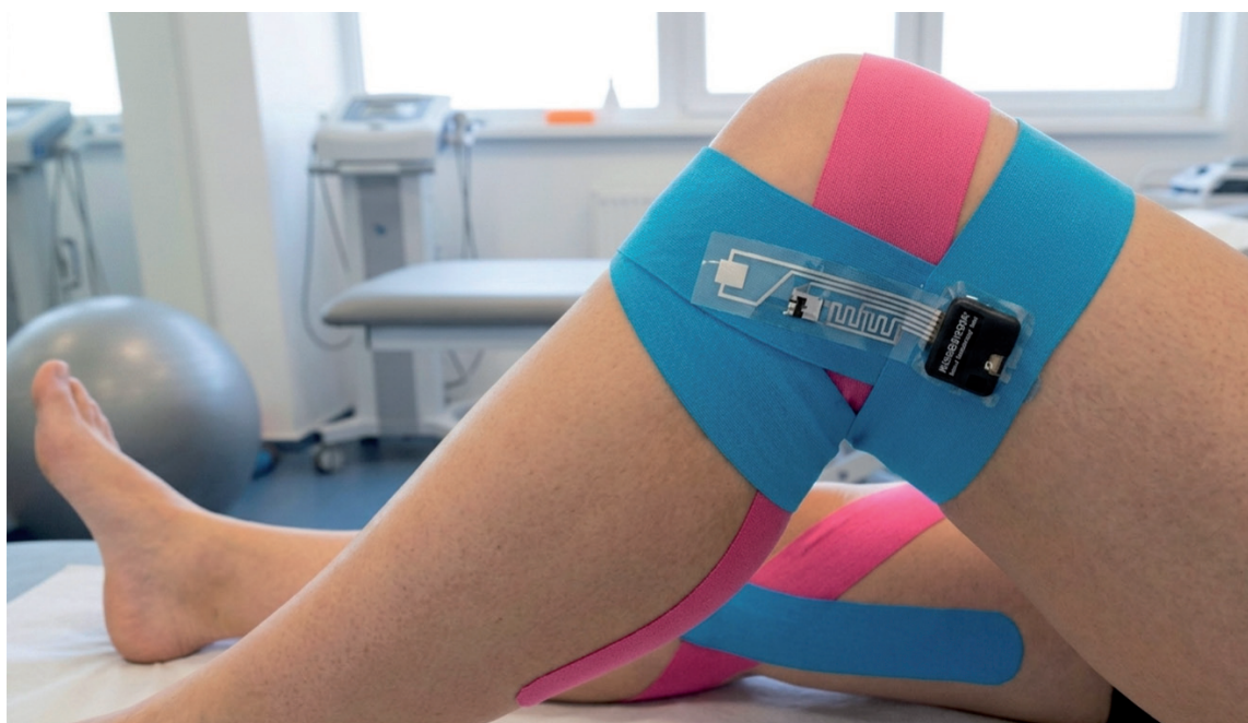
Banda inteligente con sensores flexibles para monitoreo de rodilla
