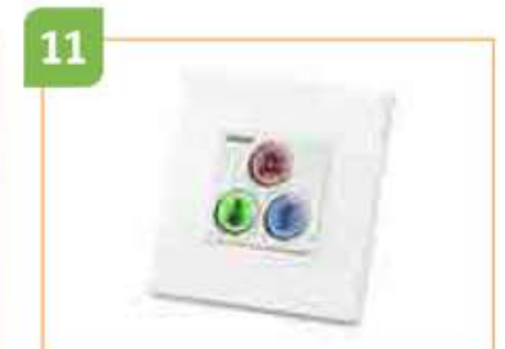
11 Mecanismos de aviso y cancelación. Los botones iluminados permiten generar llamadas de petición de ayuda, urgente y alarma médica. Opción RFID para facilitar el registro del personal y disponer de una completa trazabilidad.
